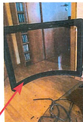
6. Vorh. Türdichtung falls erforderlich erneuern
